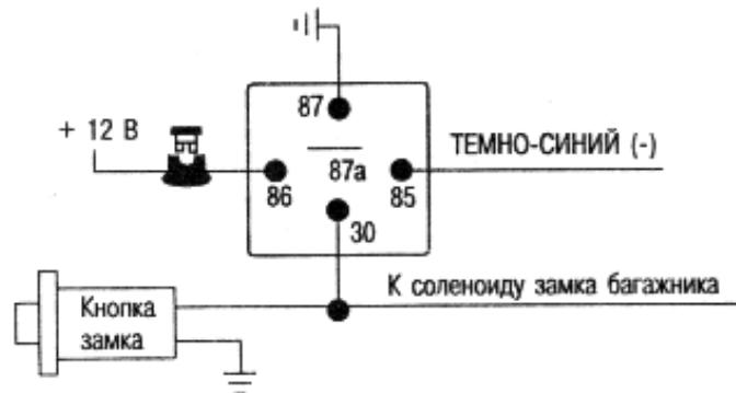
**Подсоединение:** Подсоедините ТЕМНО-СИНИЙ провод к клемме # 85 дополнительного 30 А реле и подсоедините остальные контакты реле в соответствии с выбранной функцией Канала 2. (см. схему)
