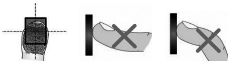
Рис. 5.3. Неправильная постановка пальца на сканер
