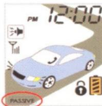
Если включена автоматическая постановка на охрану, система включит режим охраны и запрет двери через 30 секунд после открытия и закрытия двери при выключенном зажигании. При этом, каждые 10 секунд система будет подавать звуковой и световой сигнал, предупреждая о том, что идет процедура автопостановки на охрану.
