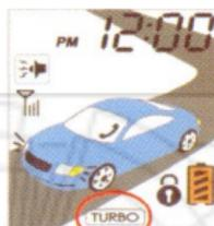
Примечание: Включение функции запрета дистанционного запуска при не затянутом ручном тормозе запрещает включение турбо таймера при незатянута ручном тормозе как для механической, так и для автоматической КПП
