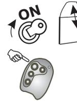
Замки дверей запираются при постановке на охрану и отпираются (все или только замок двери водителя) при снятии с охраны. При установках п.5.5 в режиме СНЯТО С ОХРАНЫ возможно также управление замками дверей включением зажигания: при подаче зажигания замки запираются сразу, либо через 10 секунд. Эту функцию можно однократно отменить, если включить зажигание при открытой двери.
