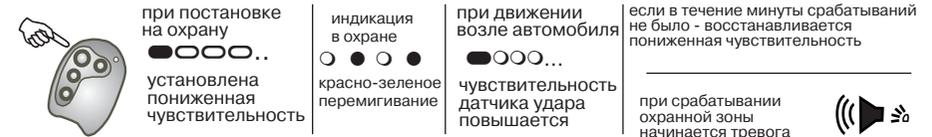
Интеллектуальный режим охраны предоставляет возможность отключать световые сигналы и "вежливую подсветку салона", звуковые сигналы, а также не передавать сигналы на пейджер MS при срабатывании внешней зоны микроволнового датчика (п.4.1. таблицы программирования).
