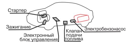
Блокировка должна препятствовать несанкционированному запуску двигателя и его работе в режиме ОХРАНА, а также выключать двигатель при срабатывании функции противоразбоя (отсутствии противоразбойной карточки в салоне при работающем двигателе в режиме СНЯТО С ОХРАНЫ). Типовые блокируемые элементы показаны на рисунке. Они задаются при установке.
