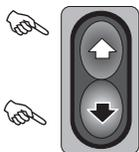
Для ввода одной цифры требуемого пункта таблицы программирования надо требуемое число раз коротко нажать на одну из кнопок кодо-наборного переключателя. Нажатия сопровождаются короткими звуковыми сигналами.
