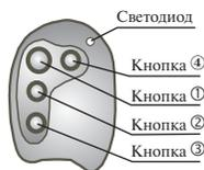
Для управления комплексом СТАЛКЕР LAN 2.2 могут быть использованы различные модификации брелока с кодом D<sup>2</sup>. Обратите внимание на расположение кнопок на Вашей модификации. Характерный признак брелока с этим кодом - при выполнении до трех коротких и длинных нажатий на кнопку ② (предварительная часть кода команды) светодиод брелока повторяет набранный код зелеными вспышками. Код посылается при нажатии кнопки ① (либо ③ либо ④). В течение послышки светодиод брелока светится красным светом.
