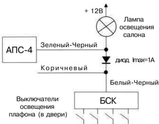
3. Рекомендуемая схема подключения ЗЕЛЕНОГО провода системы ("отрицательный триггер капота/багажника") к подкапотной лампе автомобилей ВАЗ семейств 2109, 2115, 2123 или лампе освещения багажника автомобилей ВАЗ семейства 2115:
