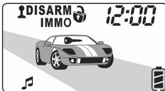
Если зажигание будет выключено, то через 30 секунд режим тревоги выключится до следующей попытки завести двигатель. Если же зажигание останется включенным – режим тревоги продолжится, но не более 3 минут. Затем режим тревоги выключится, но двигатель останется заблокированным.
