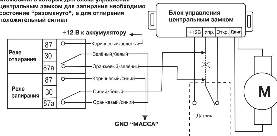
Автомобили, в которых управление центральным замком происходит отрицательным импульсом
