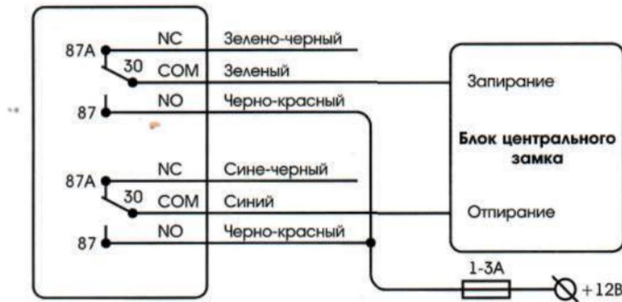
Подключение к штатному блоку с негативным управлением (импульс 0.8 с)
