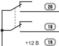
Для подключения световой сигнализации используются нормально разомкнутые контакты реле: 18 – “Фонари правого поворота” и 20 – “Фонари левого поворота”. Напряжение “+12 В” поступает на реле по проводу 19 через предохранитель 10 А.
