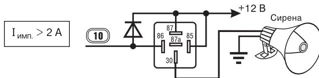
Дополнительное реле можно не использовать, если ток, потребляемый сиреной, не превышает в импульсе 2 А.
