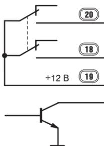
Для подключения световой сигнализации используются нормально разомкнутые контакты реле: 18 – “Фонари правого поворота” и 20 – “Фонари левого поворота”. Напряжение “+12 В” поступает на реле по проводу 19 через предохранитель 10 А.
