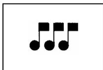
**3 КОРОТКИХ СИГНАЛА ЗУММЕРА И СВЕТОДИОДА ПРИ СРАБАТЫВАНИИ РАДАРНОГО ДАТЧИКА**
