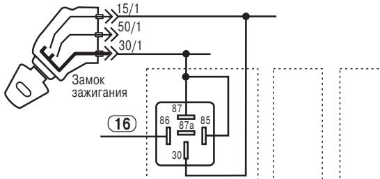
Выход дополнительной блокировки активен (низкий уровень) при включении поддержки зажигания.
