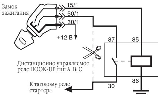
Для данной схемы подключения включение стартера должно производиться после опознавания "метки", но не так критично во времени, как для предыдущей схемы.
