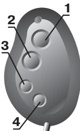
Брелок системы имеет четыре кнопки и позволяет подавать девять команд: четыре команды непосредственно нажатием соответствующей кнопки, три команды удерживанием кнопки 4 и нажатием одной из трех оставшихся, а также две команды удерживанием кнопки 3 и нажатием кнопки 1 или 2. Первая и вторая кнопки жестко закреплены за определенными функциями. Функциональное назначение остальных семи команд определяется при программировании системы.
