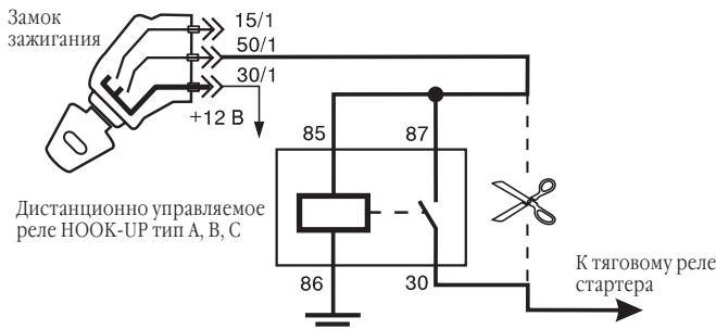
Блокировка стартера на приведенной схеме нарушает требование постоянного присутствия +12 В на выводе приема сигналов управления реле HOOK-UP®, но такое подключение предотвращает включение стартера при работающем двигателе.
