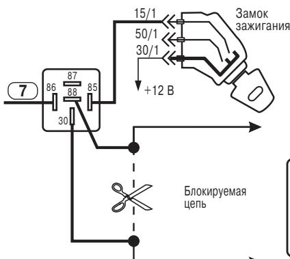
Питание "+12 В" на контакт 85 реле дополнительной блокировки необходимо подавать от контакта 15/1 замка зажигания.
