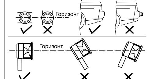
В зоне действия датчиков не должно быть выступающих элементов автомобиля
